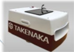
墨出しロボット
